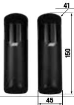
ACG8046 NOVA (na/nc) alcance seleccionable 15+40m. óptica orientable 180° sincronismo hasta 4 pares gestiona 2 bandas no/nc 8.2KΩ IP 44 - 12/24V ca/cc
