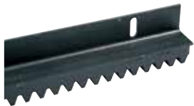
ACS9090 CREMALLERA M6 en hierro (sec. 30 x 30 mm) tratada con CATAFORESIS, con angular 45x45 mm en barras de 2 m al m
